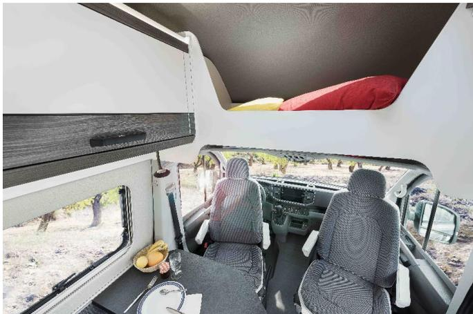
**BU:** Das GFK-Hochdach erweitert die Platzmöglichkeiten.
